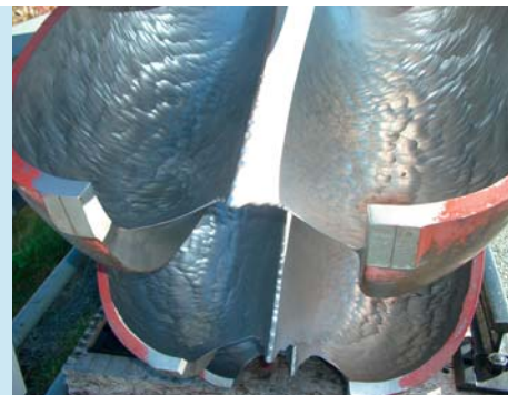
Bild 2: Verschlossener Becher einer Pelton-Turbine Fig. 2: Worn buckets of a Pelton turbine
