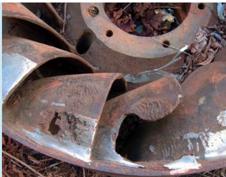
Bild 1: Kavitations-schaden an einer Francis-Turbine Fig. 1: Cavitation damage on a Francis turbine
